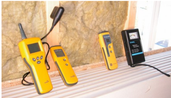
Fire forskjellige fuktmålere og fuktsøkere til forskjellig bruk: (f.v.) Protimeter MMS som kan måle fukt i alle materialer, Protimeter Timbermaster som måler i flere tresorter, Protimeter Surveymaster som pigger og søker fukt, og fuktsøkeren Tramex.
